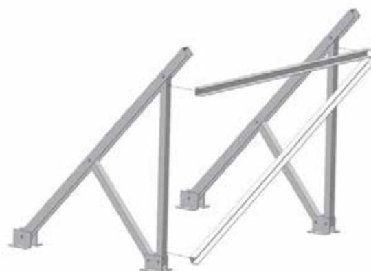
Fixez les deux profilés de renforts 6 et 7 à l'arrière des deux triangles à l'aide de vis, boulons et rondelles grower.
