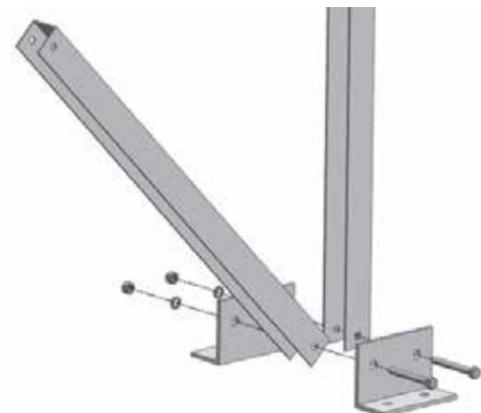
Assemblez les deux sabots 4 sur les profilés 2 et 3 à l'aide d'une vis, un écrou et une rondelle grower.
