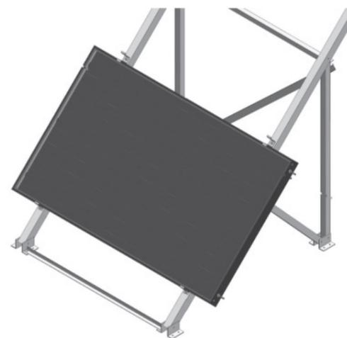
Positionnez le capteur du bas et terminez le serrage des clames du bas uniquement.
