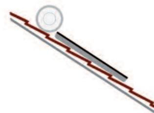
Installation parallèle au toit
