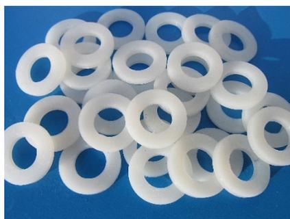
Ne pas utiliser correctement les rondelles isolantes nylon peut entraîner une corrosion des assemblages « aluminium / acier inoxydable » par phénomène électrochimique ne pouvant être couverte par la garantie.
